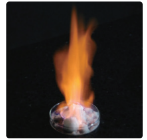
人工のメタンハイドレート 出典：メタンハイドレート資源 開発研究コンソーシアム
